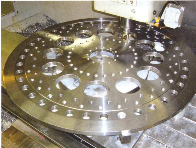
**3** Der weiche, ruhige Schnitt des Feedmasters sorgt für ein Oberflächenbild, mit dem das nachfolgende Ausspindeln eingespart werden kann
