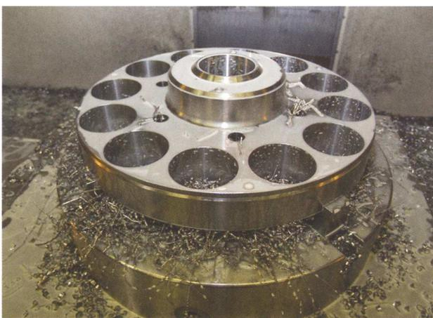
**2** Der schnell laufende ›Feedmaster‹ von Seco Tools kombiniert kleine Schnitttiefen mit gleichmäßiger Schneidenbelastung und hoher Prozesssicherheit
